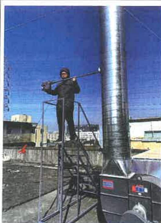
印刷废气处理后检测口（第一天）
