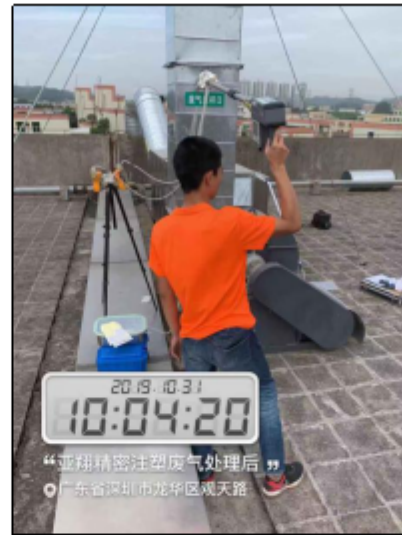
工业废气处理后检测口
