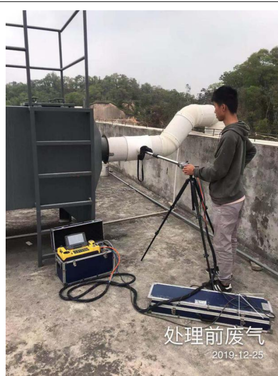
工业废气处理前检测口
