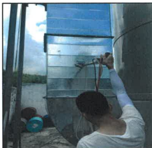
图 5 有机废气处理前采样照片
