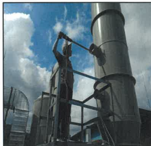
图 6 有机废气处理后采样照片
