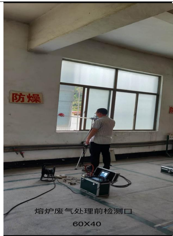
废气处理前检测口
